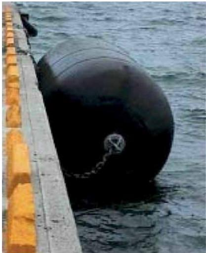
Рис.1.1 Плавучий пневматический кранец
