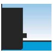
Большинство паромов, некоторые сухогрузные суда и много контейнерных судов имеют выступающий бандаж. Данный бандаж расположен по прямоугольной части корпуса и может быть прерывистым и/или расположенным на многих уровнях. Данное устройство при плохих условиях швартовки может причинить повреждение ОУ. Бандажные секции имеют форму сечения, наиболее обычно, - квадрат или полукруг.
