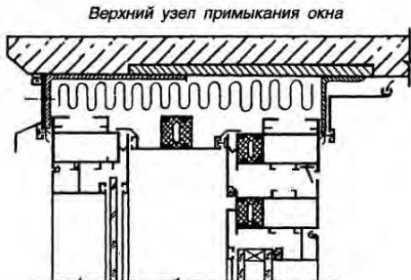
Рис. 10.19. Окна с переплетами из алюминиевых сплавов
