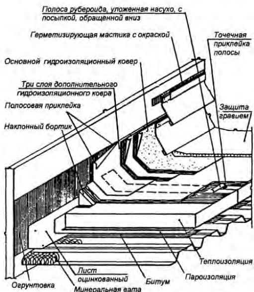
Рис. 1.7. Конструкция мягкой кровли
