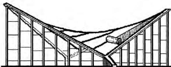
Рис. 8.51. Двухслойное мембранные покрытие в форме гипара
